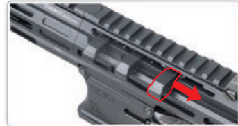
Al tirar de la palanca de carga, el perno retrocederá.
