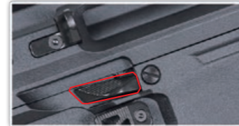
Suelte el cerrojo ficticio presionando el botón de liberación del cerrojo a cada lado del receptor.
